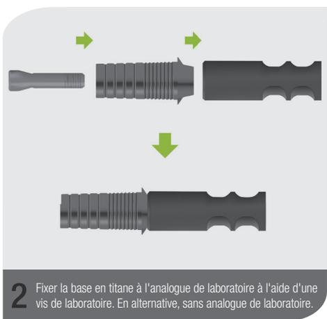
**2** Fixer la base en titane à l'analogue de laboratoire à l'aide d'une vis de laboratoire. En alternative, sans analogue de laboratoire.
